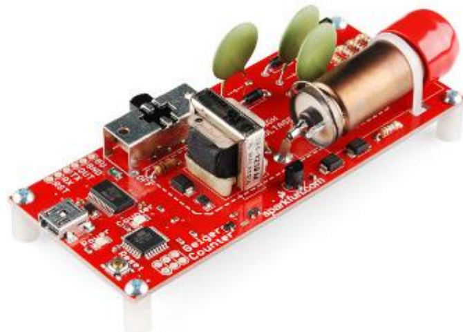
Fot. 3.5.6.5. Fabryczny moduł z licznikiem LND-712
