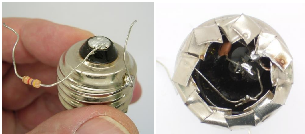
Rys. 3.5.5.2. Układ elektryczny głowicy pomiarowej ( www.elektronik-labor.de )
