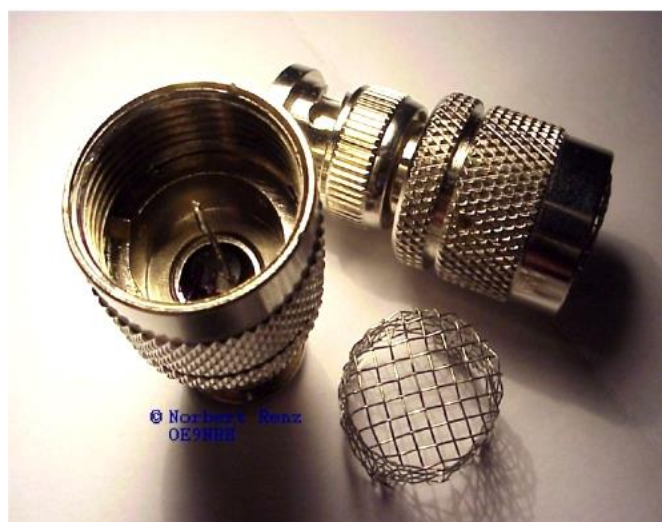
Fot. 3.5.5.1. Konstrukcja otwartej komory detektora ( www.elektronik-labor.de )
