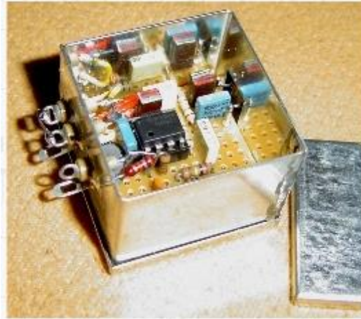
Rys. 3.5.3.2. Układ w obudowie ekranującej ( www.elektronik-labor.de )
