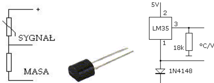
Rys. 1.6.2. (po lewej i na środku) Układ pomiarowy – dzielnik napięcia i wygląd termistora z serii KTY81-84
