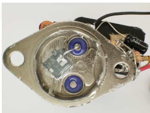
Fot. 3.5.4.1. Tranzystor BUZ45 z otwartą obudową. Struktura półprzewodnikowa pokryta warstwą ochronną
