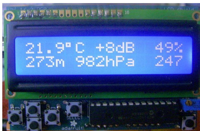
Fot. 4.2.11. Transmisja danych meteorologicznych: ciśnienia, temperatury, wilgotności względnej i wysokości zmierzonych za pomocą czujnika BME280 firmy „Bosch”. Dodatkowo wyświetlana jest informacja o sile odbieranego sygnału (odstępnie poziomu sygnału od szumu)
