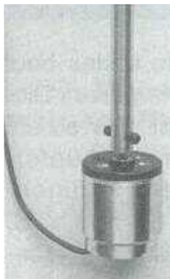
Fot. 3.1.7. Tachometryczny sposób pomiaru szybkości wiatru (źródło AATiS)
