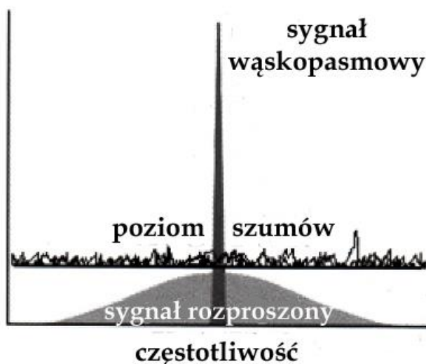
Rys. 4.2.2. Transmisja sygnału o rozproszonym widmie. Sygnał użytkowy jest po stronie nadawczej rozpraszany, a po stronie odbiorczej skupiany w identyczny sposób i przy użyciu identycznego kodu dla odzyskania danych w paśmie podstawowym. Ewentualnie odebrane sygnały wąskopasmowe znajdujące się w tym samym paśmie ulegają w odbiorniku rozproszeniu i nie powodują zakłóceń
