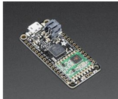
Fot. 4.1.5. Moduł packet radio z RFM69HCW
