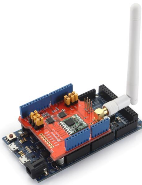
Fot. 4.2.14. Moduł nadawczo-odbiorczy z RFM98W-433S2 dla „Arduino” (źródło: exp-tech.de )
