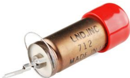
Fot. 3.5.6.4. Licznik Geigera-Müllera typu LND712 dla promieniowania alfa, beta i gamma jest wypełniony mieszaniną neonu i halogenu pod niskim ciśnieniem. Wysokie napięcie leży w zakresie 325 – 500 V
